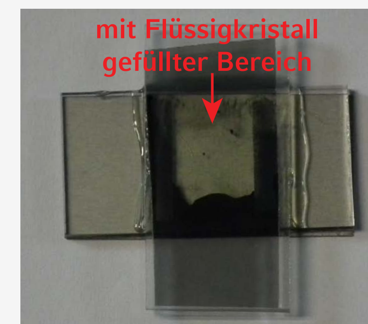
Abb. 3: Modellzelle zu 3/4 mit Flüssigkristall gefüllt
